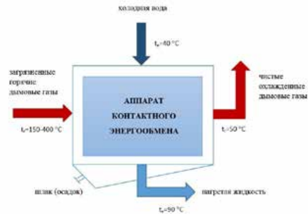
Рис. 1. Принципиальная схема устройства для реализации контактного энергообмена
