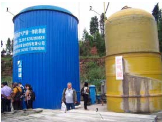
Рис. 1. Біогазова установка для забезпечення біогазом 60 будинків в м. Deyang (КНР): 1 – біогазовий реактор, 2 – газгольдер, 3 – бак з вододобірною суспензією
